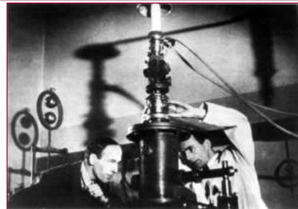
Max Knoll и Ernst Ruska 1931, първият трансмисионен електронен микроскоп (ТЕМ)
